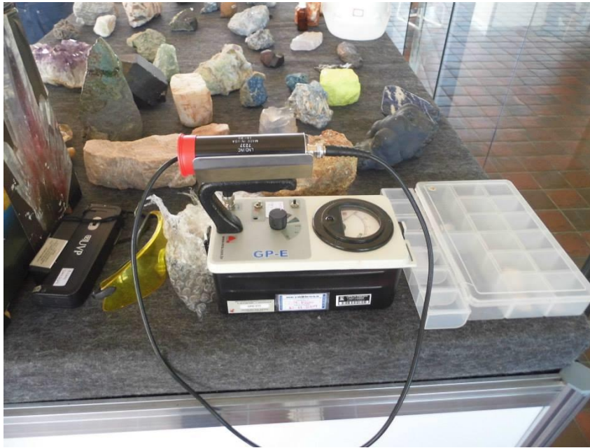
Figura 5 – Instrumentos usados na identificação das propriedades dos minerais. Cintilômetro à frente (mede a Radioatividades, lado esquerdo Mineralight (verifica a Fluorescência)
