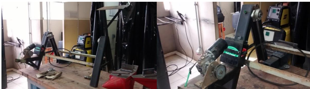
Foto 04 e 05- Montagem dos mancais de rolamento. Fonte: acervo autor
